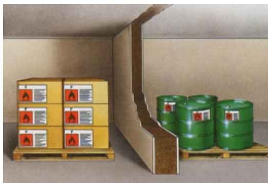
Figura 3. Almacenamiento separado de productos incompatibles
