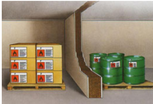
Figura 3. Almacenamiento separado de productos incompatibles
