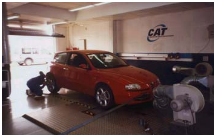
Figura 17. Banco de potencia para coches, en el que puede observarse el anclaje del vehículo antes de comenzar la prueba.
