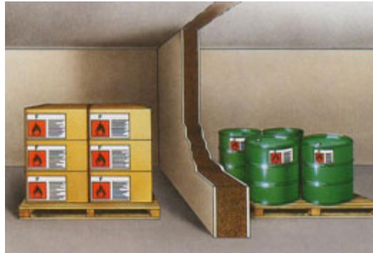
Figura 3. Almacenamiento separado de productos incompatibles
