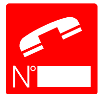
TELÉFONO PARA LA LUCHA CONTRA INCENDIOS
